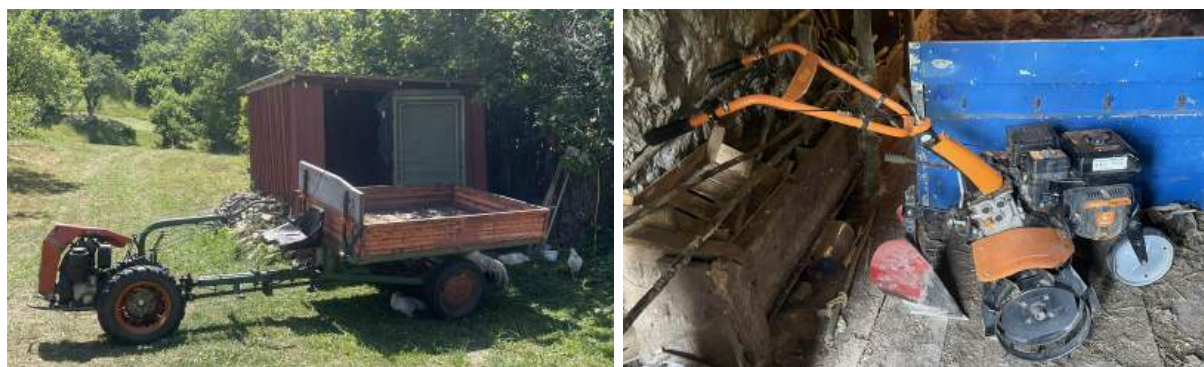
Figure II.41 : A gauche, un motoculteur avec une remorque attelée ; à droite, un motoculteur avec un buttoir attelé (source : LD & DS)
